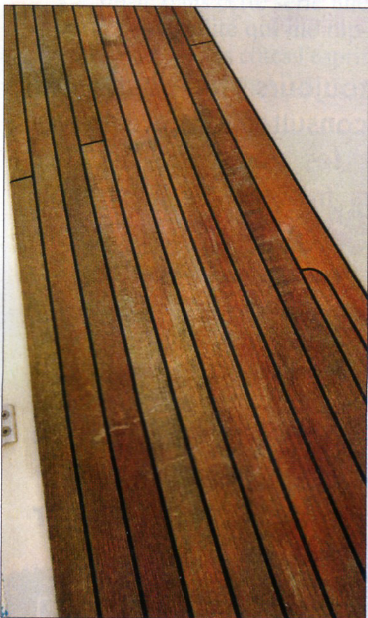
Mal protégé, ce pont teck, pourtant récent, a déjà mauvaise mine...
